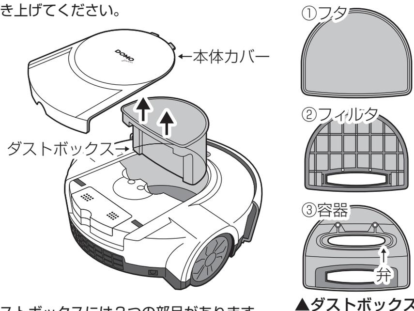
ダストボックスには3つの部品があります。「①フタ」を外すと「②フィルタ」が出ます。このフィルタを引き上げると「③容器」が出ますので、溜まったゴミを捨ててください。
