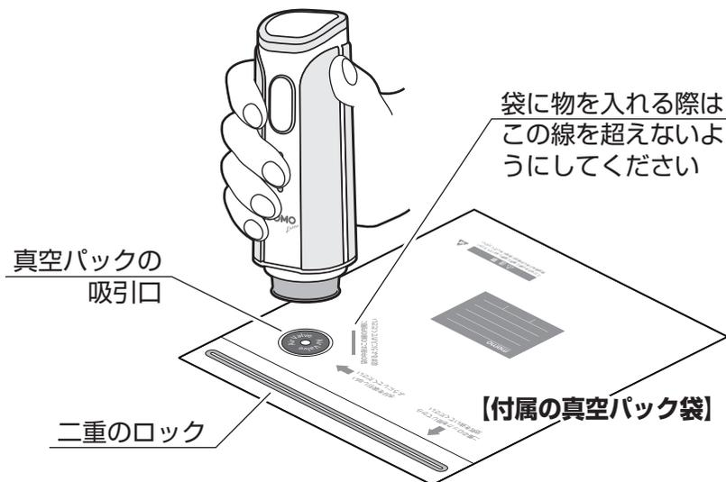
3. 正しく吸引されている場合は袋がしぼんでいきます。そのまま本体を動かさないように保持して吸引を続けると、完了した段階で自動的に電源が切れます。
